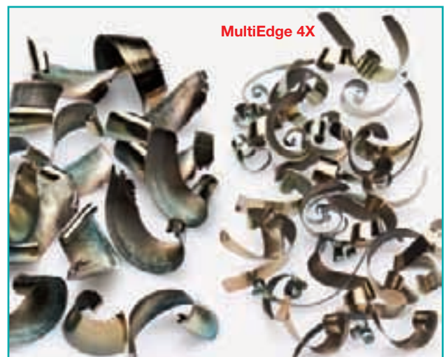
MultiEdge 4X: Kleine Späne durch Spanteilung MultiEdge 4X: Small chips because of chip division
